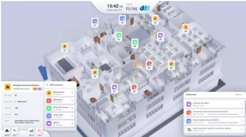
以 FioTec 開發的定制化和 3D BIM 功能儀錶板
