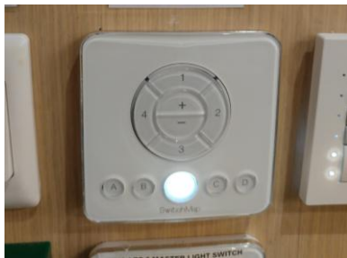
照明控制系統控制板
